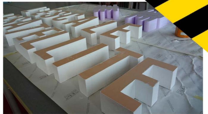
DÉCOUPE DES ÉLÉMENTS EN POLYSTYRÈNE ET PVC - MISE EN PEINTURE (sous-couche, peinture, pochoirs)
