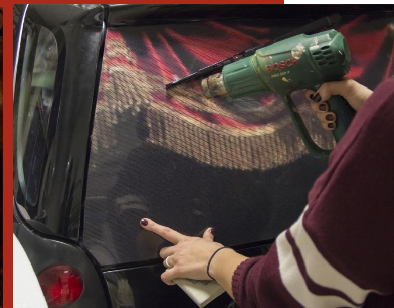
Pose d'adhésif polymère micro perforé
