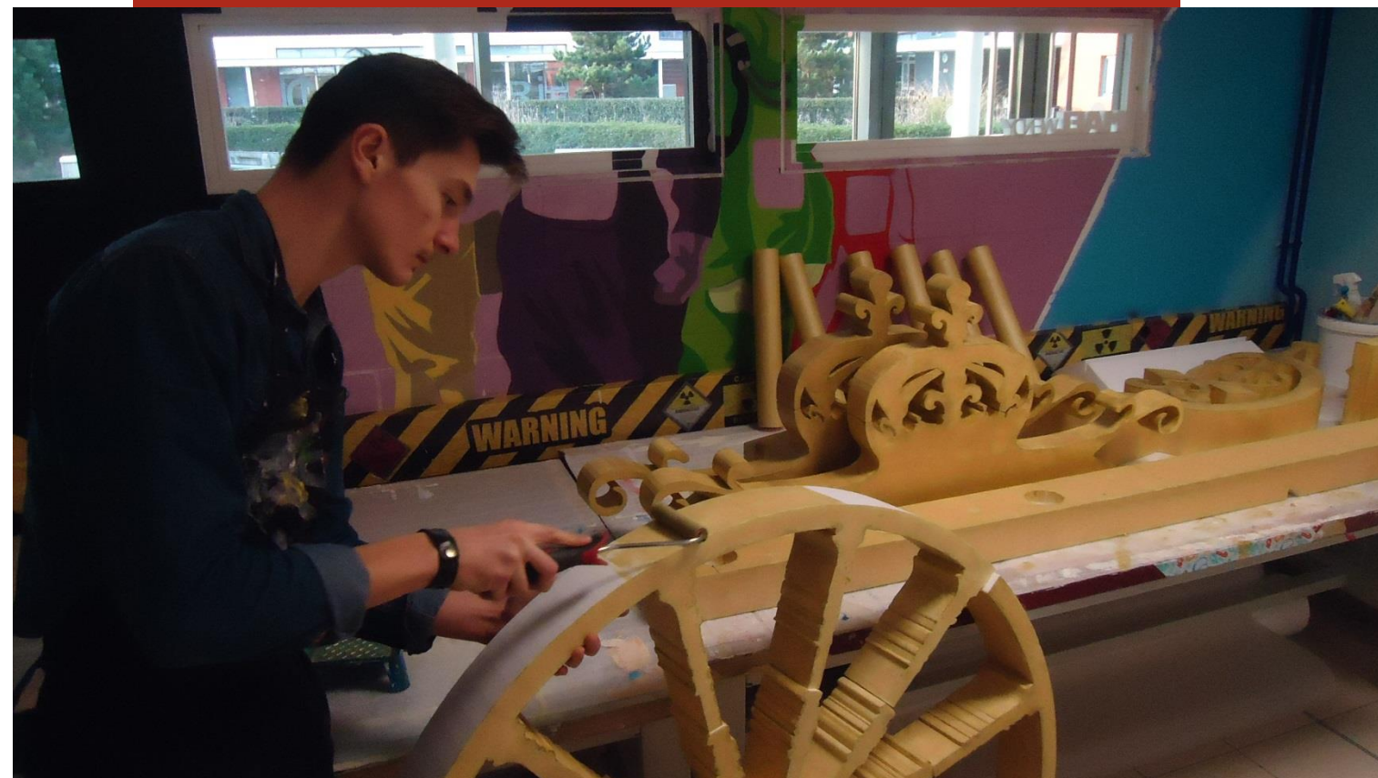
Mise en peinture des éléments de décor en polystyrène haute densité
